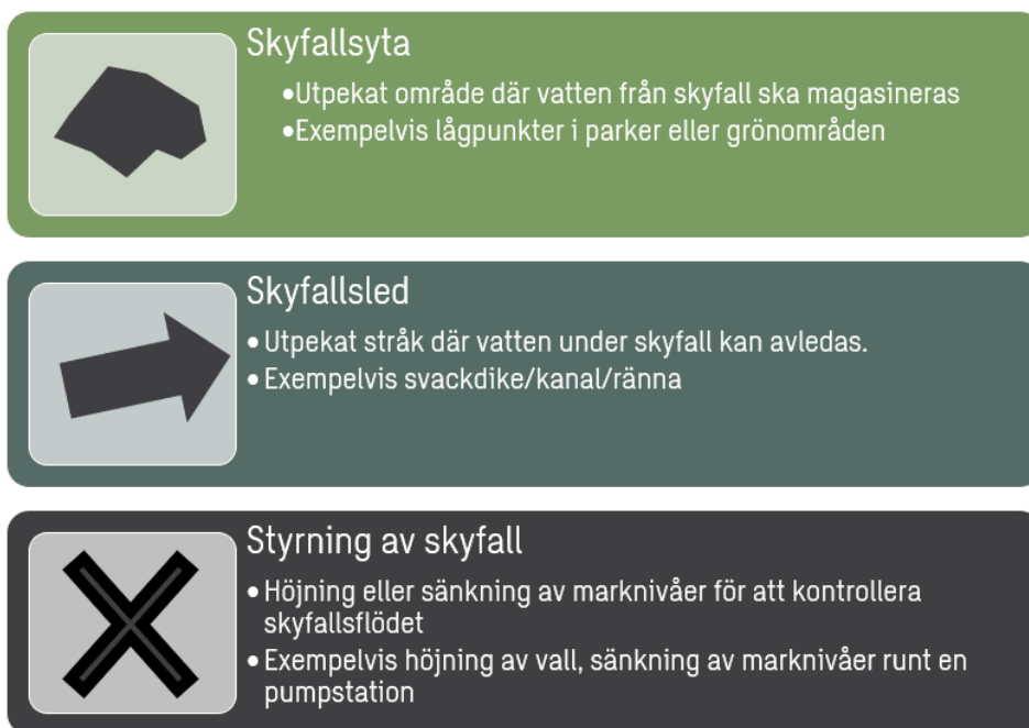
Figur 11. Schematisk illustration av tänkbara skyfallsåtgärder.
