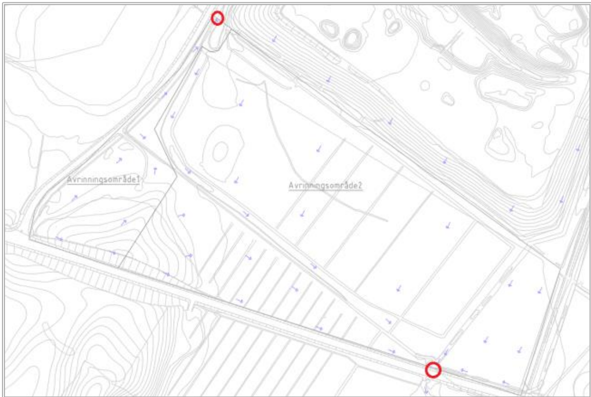
Figur 12. Befintliga avrinningsområden inom området, utsläppspunkter markerade med röd cirkel. A1 är cirka 0,9 ha stort. A2 är cirka 18 ha stort (AFRY, 2024b).
